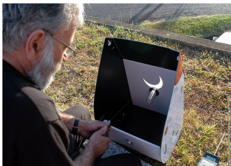
Figure 30 (page 66 du livre) : le SolarScope, exemple d'instrument permettant l'observation du Soleil en toute sécurité (photo DR).
